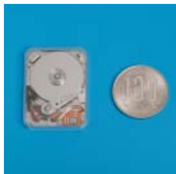
小型HDDの中でも最小になる、100円玉とほぼ同じ大きさの0.85型HDD。東芝のHDD事業のなかのキーパーツになることは間違いないだろう
