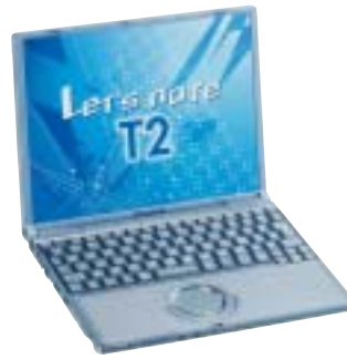
マグネシウム合金の薄型成形、液晶ディスプレイの削り出しや内部機構の工夫などにより12.1型画面で約1,070gの軽量ボディを実現したレッツノートT2
